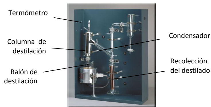
Figura 3. Sistema de destilación a presión reducida
